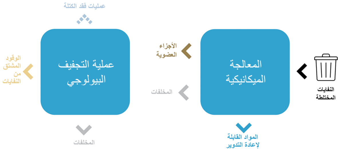
الشكل 0-6: مخطط عملية سير التجفيف البيولوجي للمعالجة الميكانيكية البيولوجية - الخيار الأول.
