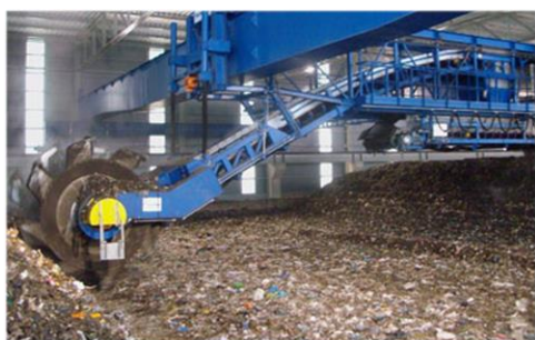
الشكل 0-4: المعالجة الميكانيكية البيولوجية – الاستقرار الهوائي - نظرة عامة على التقنية.
